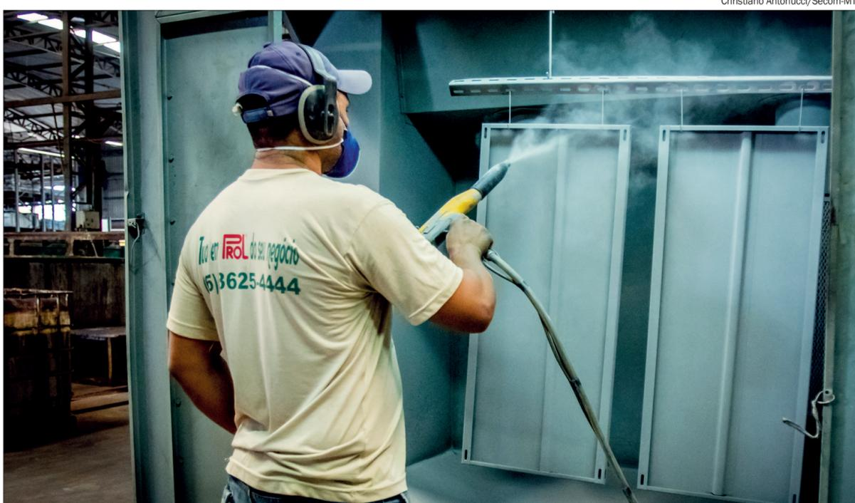
Gás natural é utilizado para aquecer água e para secar peças pintadas com o sistema de pintura a pó
